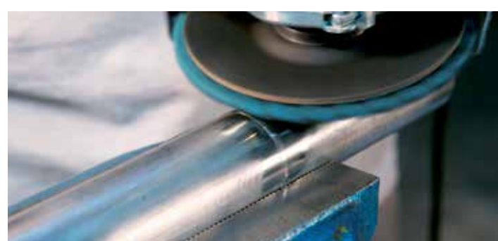
Nachbearbeitung einer Schweißnaht mit Polierfächerscheibe
