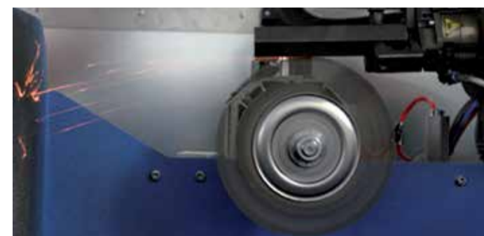
Eine Bürste produziert bis zu 95% weniger Funken als eine Schleifscheibe
