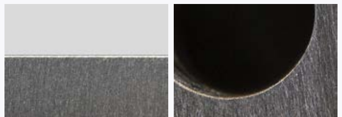
După prelucrare - Bavurile au fost îndepărtate în mod fiabil și muchiile au fost rotunjite. Suprafața are un aspect uniform, periat.
