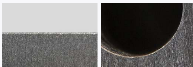
Después del mecanizado - Las rebabas se han eliminado por completo y los bordes se han redondeado. La superficie tiene un aspecto cepillado uniforme.
