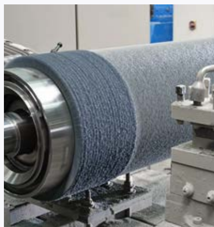
Schritt 2 - Um ein optimales Ergebnis zu erzielen, wird die Bürstenoberfläche gesichert und bearbeitet.
