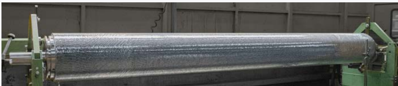
Schritt 3 - Die Bürste wird sorgfältig ausgerichtet und genau ausgewuchtet, um optimale Ergebnisse zu erzielen.
