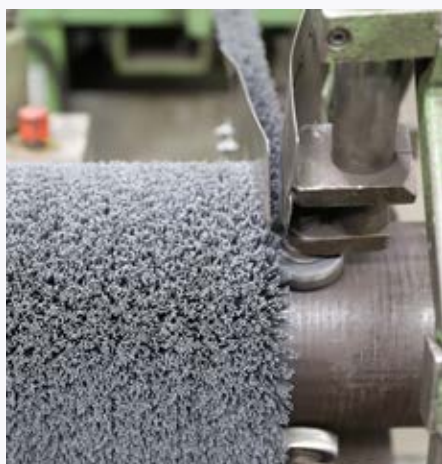
Schritt 1 - Der Altbelag wird vollständig entfernt und die Rolle wird mit neuem Besatzmaterial montiert
