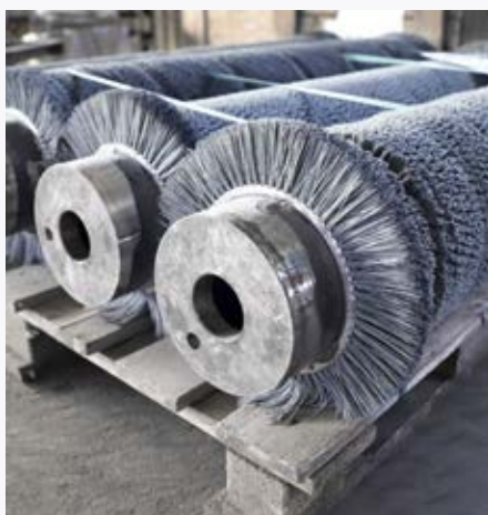
Vorher - der Besatz ist abgenutzt und muss erneuert werden
