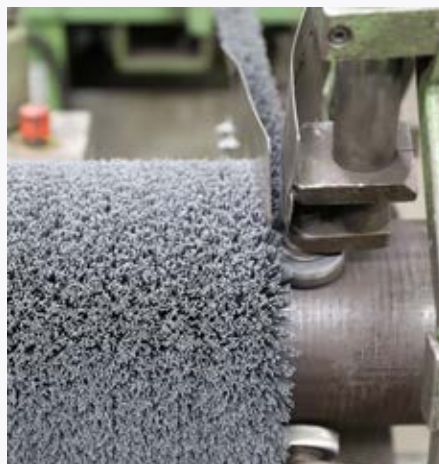
Paso 1 - El material usado se retira completamente y el rodillo se rellena con material nuevo.
