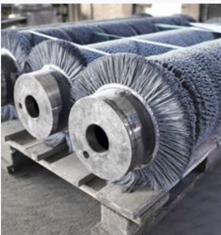
Antes - el cepillo está desgastado y hay que rellenarlo
