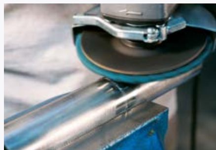
Levigatura di cordoni di saldatura sottili e rimozione della decolorazione termica
