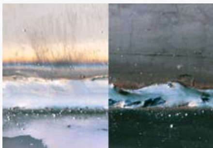
Le superfici decalcificate prima della saldatura danno luogo a cordoni di saldatura puliti (vedi immagine a sinistra)
