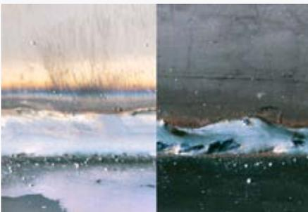
As superfícies descalcificadas antes da soldadura resultam em cordões de soldadura limpos (ver imagem à esquerda)
