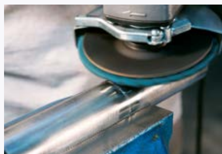
Slipning av fina svetsfogar och borttagning av termisk missfärgning
