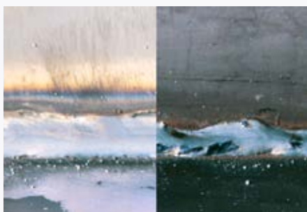
Ytor som rengörs före svetsning ger rena svetsfogar (se bilden till vänster)
