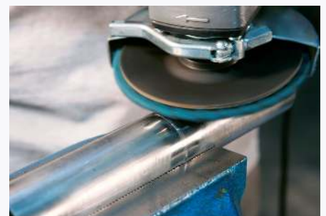
Fijne lasnaden schuren en thermische verkleuring verwijderen
