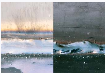
Oppervlakken die voor het lassen worden ontlakt, resulteren in schone lasnaden (zie afbeelding links)
