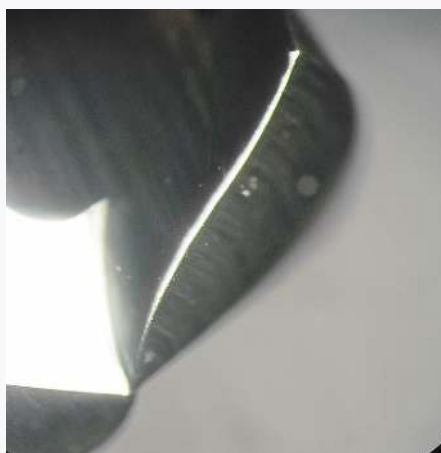
Lavorata con spazzola Ø150 SIC abrasivo in nylon grana 180
