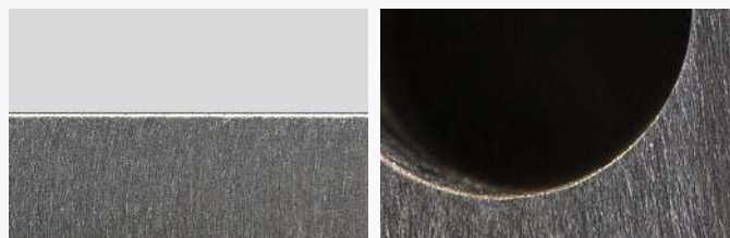
Dopo la lavorazione - Le bave sono state rimosse in modo affidabile e i bordi sono stati arrotondati. La superficie ha un aspetto uniforme e spazzolato.
