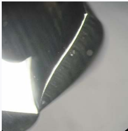
Bewerkt met wielborstel Ø150 SIC abrasief nylon korrel 180
