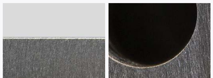
Na bewerking - Bramen zijn verwijderd en de randen zijn afgerond. Het oppervlak heeft een uniform, geborsteld uiterlijk.
