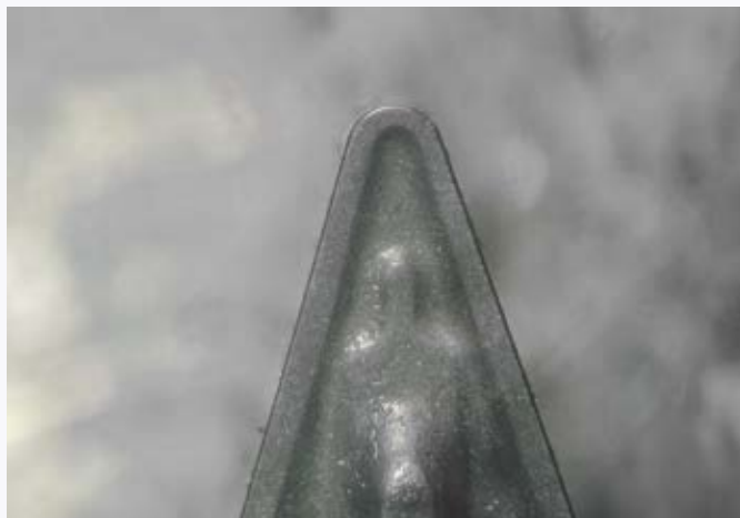
Insert métallique en carbure, usiné
