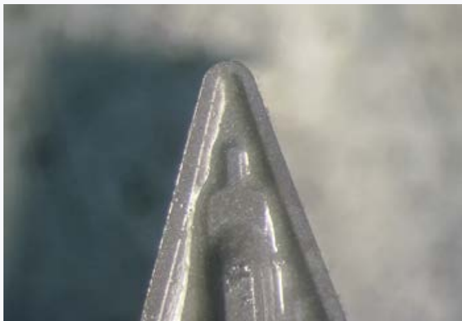
Insert métallique en carbure, non usiné
