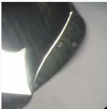
Obróbka ściernicą borstel Ø150 SIC ścierniwo nylonowe ziarnistość 180
