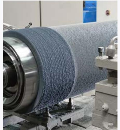
Schritt 2 - Um ein optimales Ergebnis zu erzielen, wird die Bürstenoberfläche geschert und bearbeitet.
