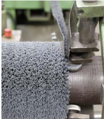
Schritt 1 - Der Altbelag wird vollständig entfernt und die Rolle wird mit neuem Besatzmaterial montiert
