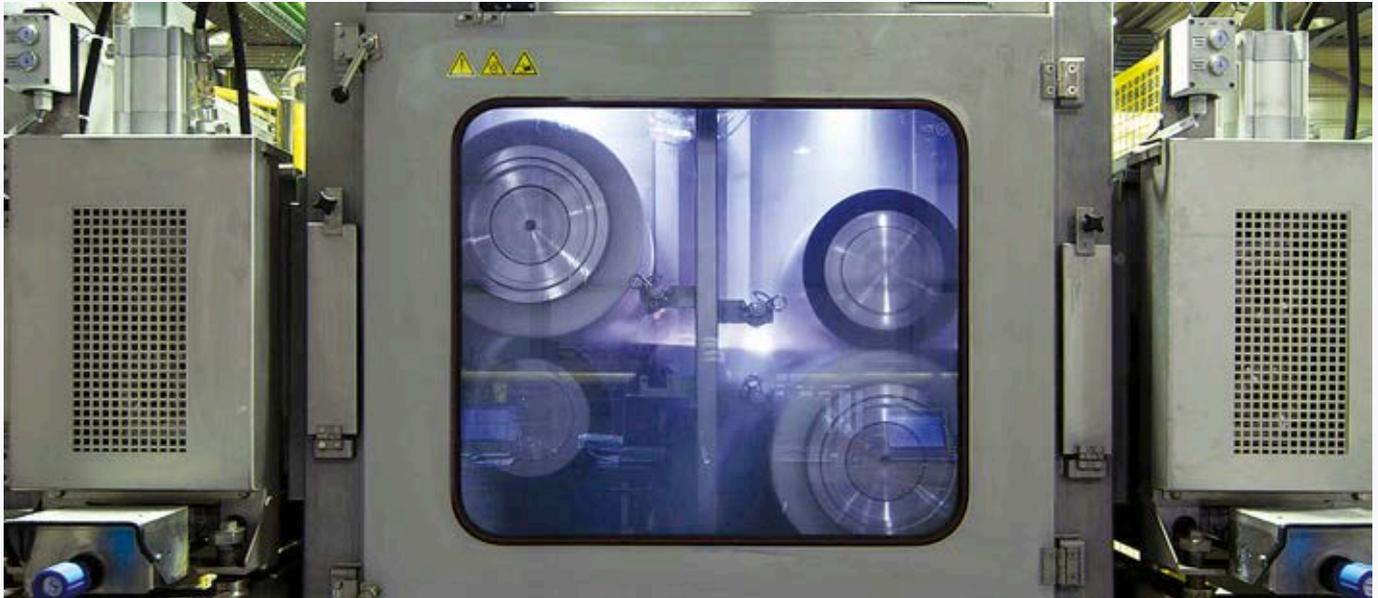
Je nach Art und Verschmutzungsgrad des Vormaterials und der für den Bearbeitungsschritt erforderlichen Bandsauberkeit werden unterschiedliche Anforderungen an die Bürste gestellt. Während mit nicht abrasiven Multifilamenten eine optimale Entfettung und Feinstreinigung erreicht werden kann, sind abrasive Besatzmaterialien ideal, um stark anhaftende Partikel aus dem vorangegangenen Walzprozess zu entfernen.
