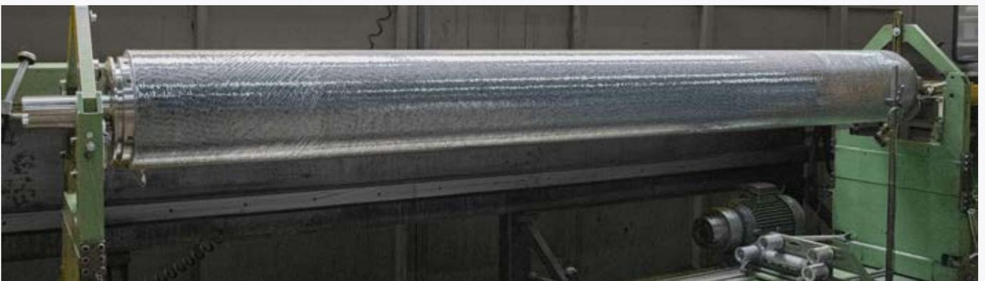
Schritt 3 - Die Bürste wird sorgfältig ausgerichtet und genau ausgewuchtet, um optimale Ergebnisse zu erzielen.
