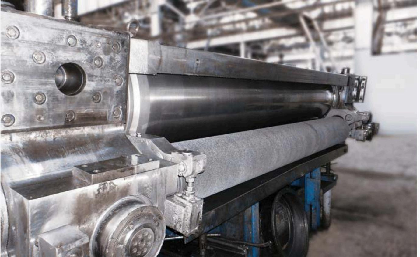
Die Helimaster-Bürstenwalzen von Osborn eignen sich hervorragend für die Reinigung von Arbeits- und Stützwalzen in nass oder trocken betriebenen Walzwerken und Dressiergerüsten. Sie werden seit Jahrzehnten weltweit in technologischen Entwicklungen eingesetzt, sowohl in Online-Anlagen, die in Bandanlagen integriert sind, als auch in eigenständigen Offline-Walzgerüsten.
