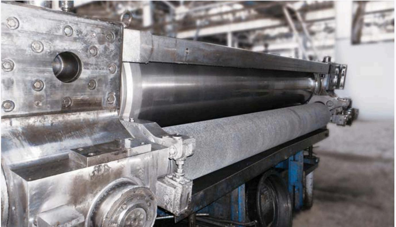
I rulli con spazzole Helimaster di Osborn sono perfetti per la pulizia e come rulli di supporto nei laminatoi a umido o a secco e nei laminatoi skin-pass. Da decenni vengono utilizzati in tutto il mondo in applicazioni tecnologiche avanzate, sia in linee online integrate in linee di laminazione di nastri che in gabbie di laminazione offline autonome.
