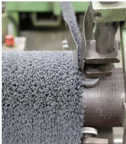
Fase 1 - Il materiale usurato viene completamente rimosso e il rullo viene ricoperto con materiale nuovo.
