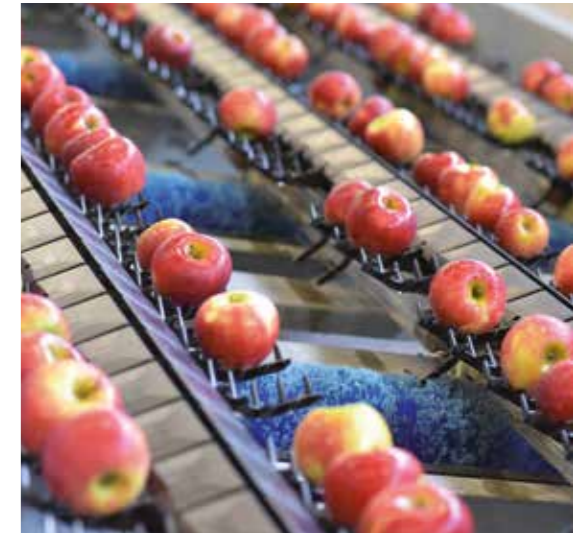
MultiZack® Bürsten werden z.B. zum Reinigen, Transportieren und Polieren von Früchten oder Gemüse eingesetzt.
